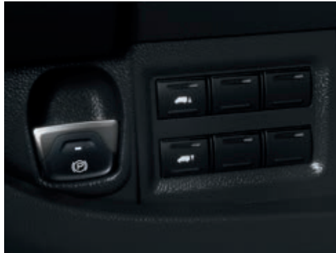
Uusi sähköinen pysäköintijarru lisää jokapäiväistä mukavuutta. Kuljettaja voi aktivoida jarrumekanismiä kojelaudassa sijaitsevalla kytkimellä. Mittaristopaneelin asetuksella pysäköintijarrun voi asettaa kytkeytymään myös automaattisesti.
