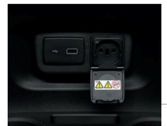
An der 230-V-Steckdose können elektronische Geräte wie Laptops, Tablets, Smartphones, Akkus für Elektrowerkzeuge und sonstige Geräte mit einer Leistungsaufnahme bis 150 Watt aufgeladen werden.
