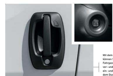
Mit dem Keyless Entry & Go System können Sie die Türen für Fahrgastzelle, Aufbau und Laderaum ver- und entriegeln sowie den Motor ein- und ausschalten - einfach mit dem Ducato Schlüssel in der Hosentasche.
