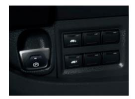
Die elektrische Feststellbremse erhöht den Fahrkomfort im Alltag. Der Mechanismus kann vom Fahrer über einen speziellen Schalter am Armaturenbrett eingeschaltet werden. Die Funktion lässt sich sogar über eine spezielle Einstellung am Kombiinstrument aktivieren.
